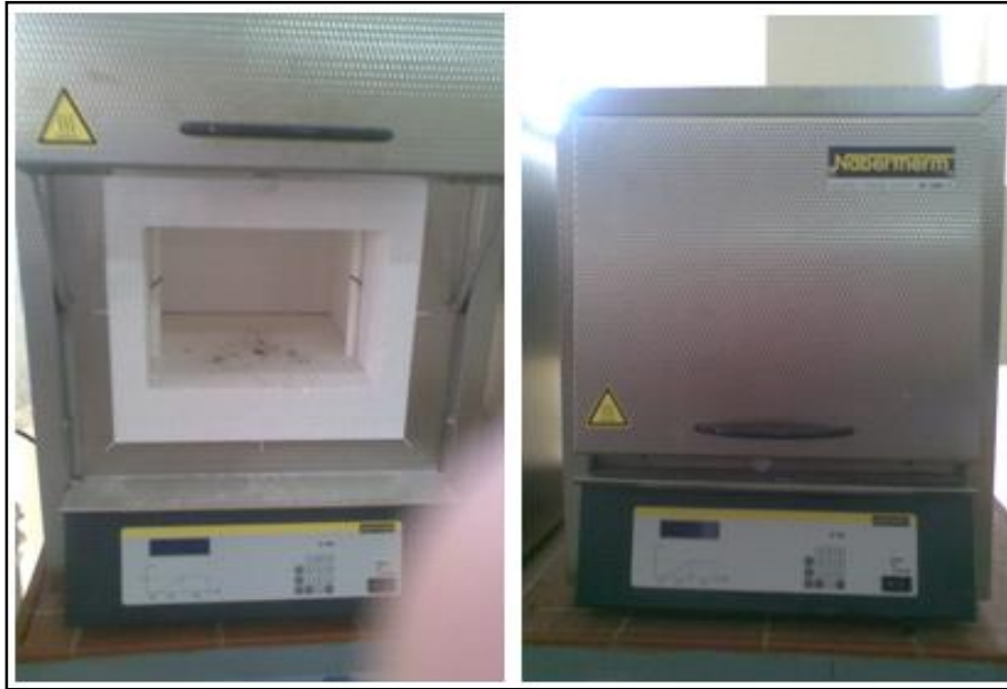
Figure 3.13 : Four à moufle Nabertherm de type LT5/12
