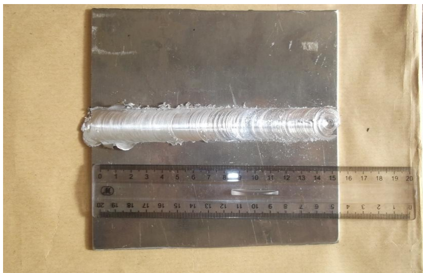
Figure 3.9 : Cordon de soudure FSW obtenu
