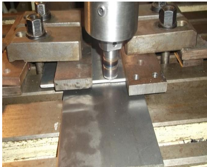
Figure 2.10: Opération de soudage FSW
