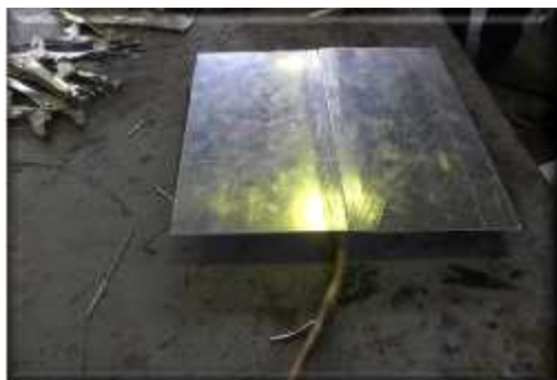
Figure(II.5) : Préparation de Soudure avec Protection ep 2 mm
