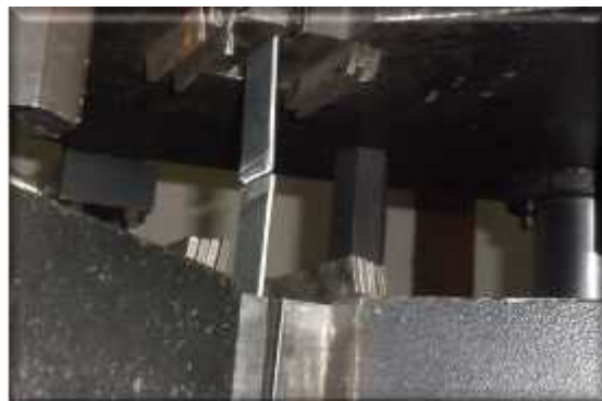
Figure(II.24) : Eprouvette au cours l'essai de Traction ep 2 mm
