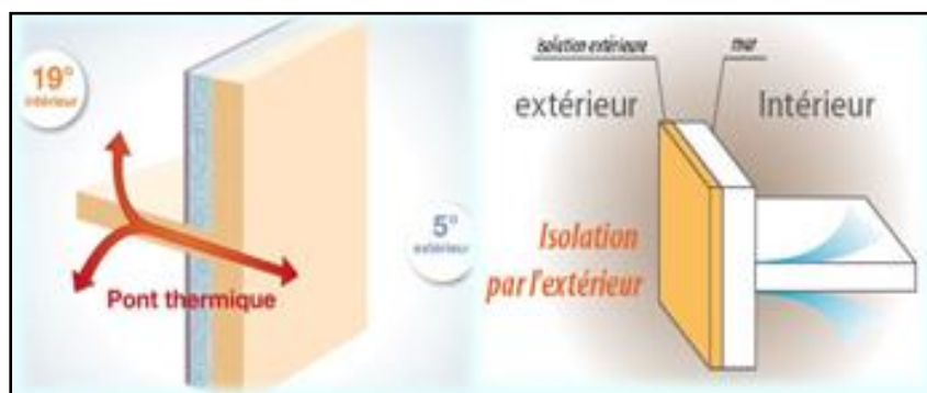
Figure 19 Parois isolées par extérieur et intérieur.
