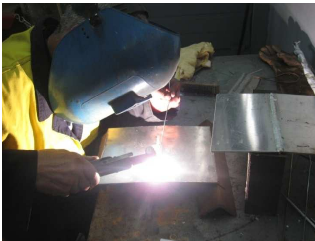
Figure II.9 : Application du procédé de soudage TIG
