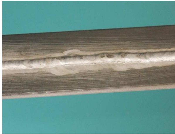
Figure II.12 : Apparition d'une fissure lors du soudage TIG d'un alliage D'aluminium 7075 T6 (épaisseur = 2 mm)
