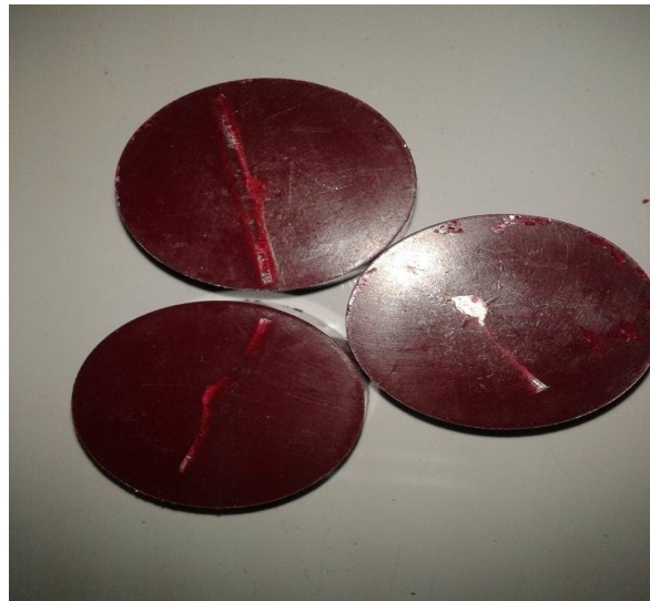
Figure III.13 : Talons de soudure enrobée par la résine.
