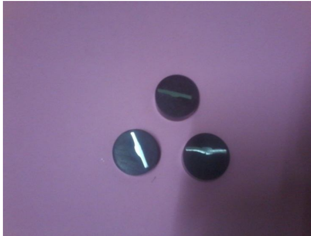
Figure III.17 : Après polissage le cordon de soudure enrobé par la résine.
