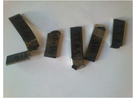
Les éprouvette avec T.T puis le soudage MIG
