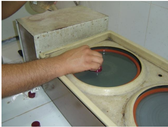
Figure III.15 : 1 ère Etape de Polissage.
