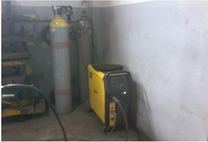
Figure III.5 : Poste de soudage MIG (MigC340 PRO).
