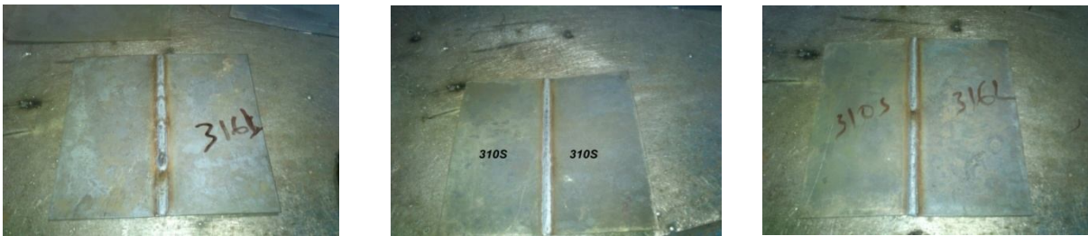
Figure III.9 : les pièces subissent un traitement thermique puis le soudage MIG.
