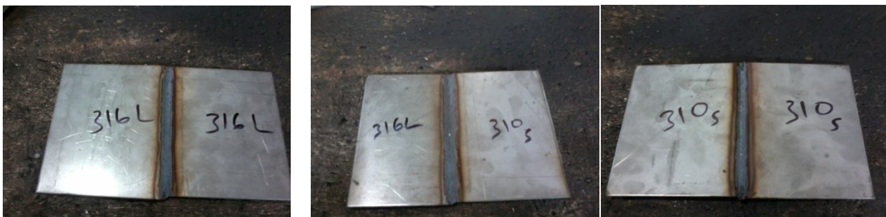
Figure III.10 : les pièces soudées sans T.T.
