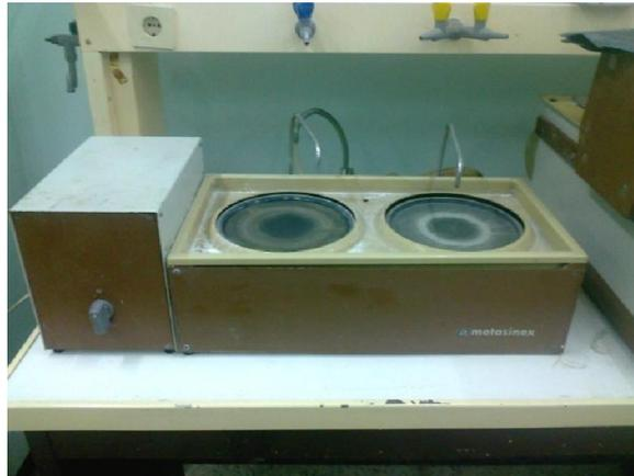
**Figure IV-6 :** La polisseuse utilisée dans l'étude.
