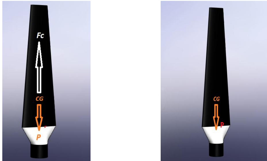
Figure V.3 – Les forces d’inerties dans le cas rotatif et statique d’hélice
