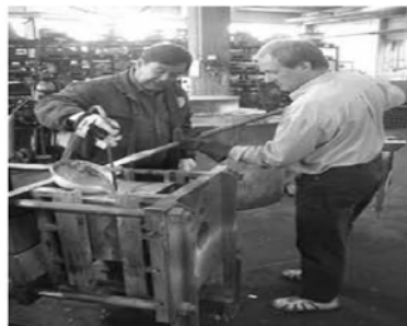
Figure (I.7) : Photographie de la coulée par gravité d'alliages de magnésium (Fonderie SpecialValimo, Finlande).
