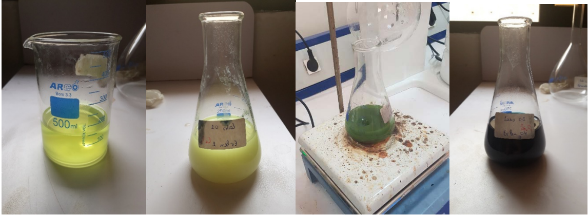
Figure (IV.7) : Préparation de revêtements de conversion d'oxyde de Chrome, cérium silicium et l'antimoine
