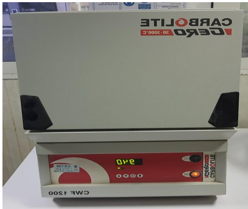
Figure III.7: Le four de calcination à 950^{\circ}\text{C}
