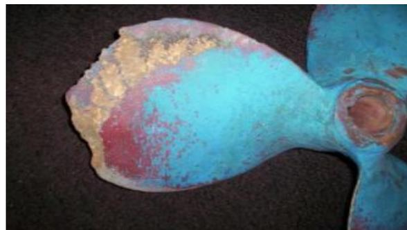
Figure II.14- l'effet de cavitation sur les structures solides.
