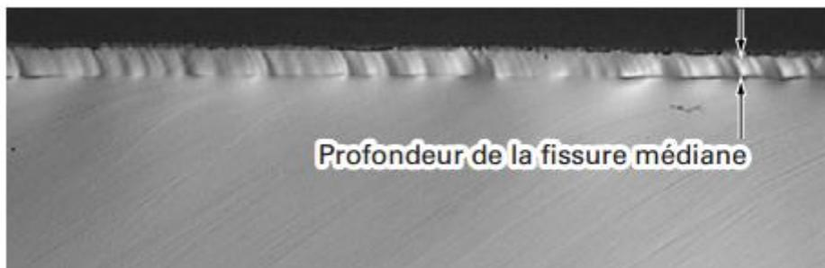
**Figure 4.4** Vue sur un bord de découpe du tracé de la fissure
