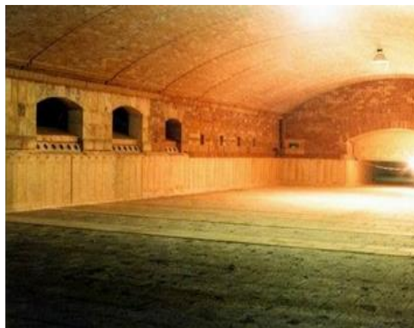
Figure II.10 : Chambre de fusion (Four industrielle MFG).
