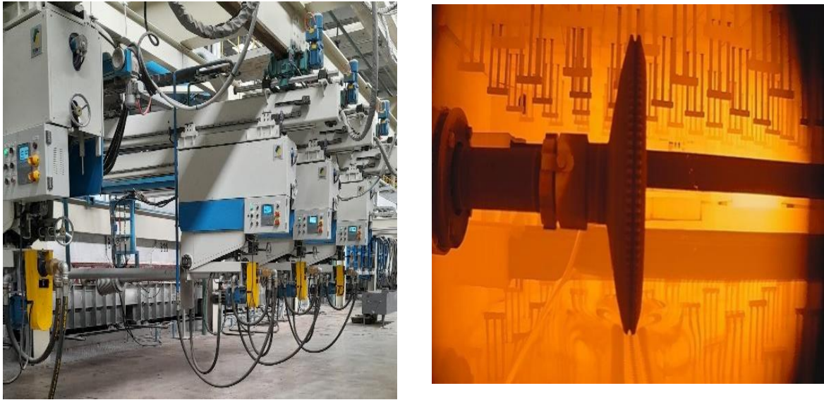
Figure II.11 : Top rollers à l'extérieur et à l'intérieur du bain d'étain.
