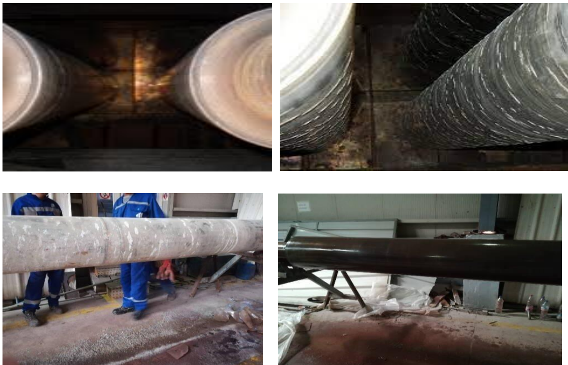
Figure III.9 : Les rouleaux avant le nettoyage et après.
