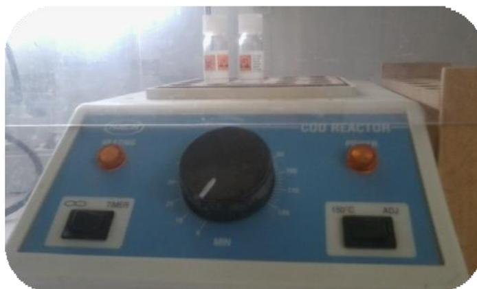
**Figure 6 : « Réacteur DCO » (λ= 620nm).**
