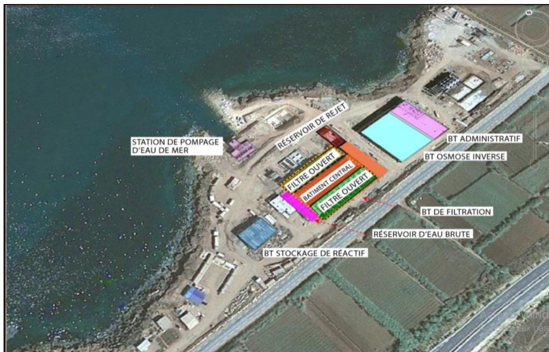
Figure II.5. Structure de l'usine de dessalement de Fouka.
