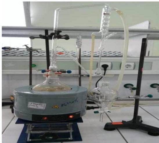
**Figure II.3 :** Dispositif d'extraction Clevenger
