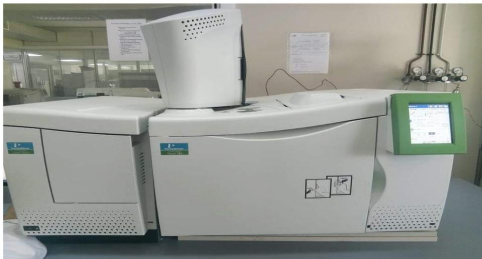
**Figure II.5 :** Appareil de chromatographie en phase gazeuse couplée à une spectrophotométrie de masse
