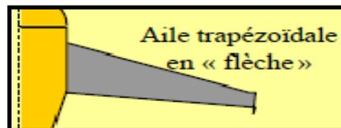
Figure (I.11) voilure en flèche
