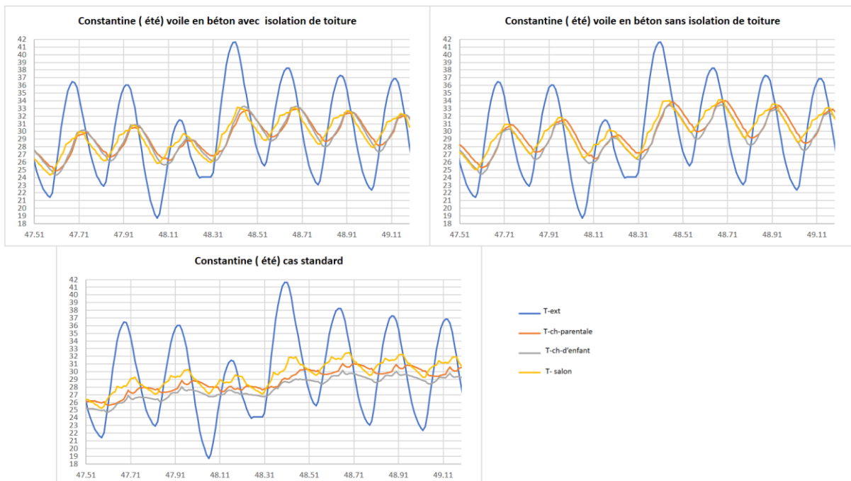
Figure 57 : Evaluation des températures intérieures de la maison (en cas standard & murs en voile en béton) pour la ville de Constantine, pendant la semaine estivale la plus défavorable.
