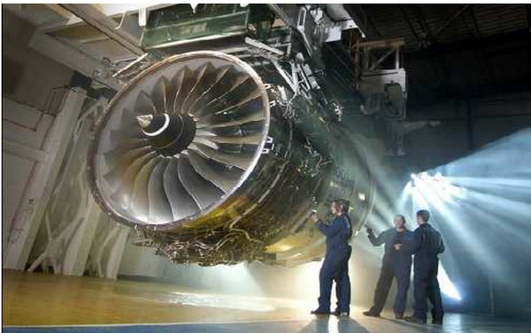
- Figure I.6 : Préparation du Trent 1000 Rolls-Royce en vue de son premier démarrage -
