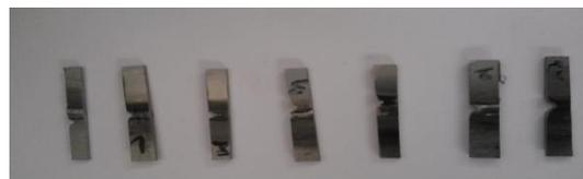
Figure III.11 : les éprouvettes de résilience.
