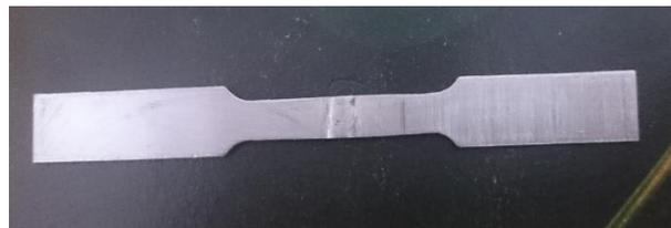
**Figure III.14 :** L'éprouvette de traction la norme ASTM (E8/E8M – 09) [33]
