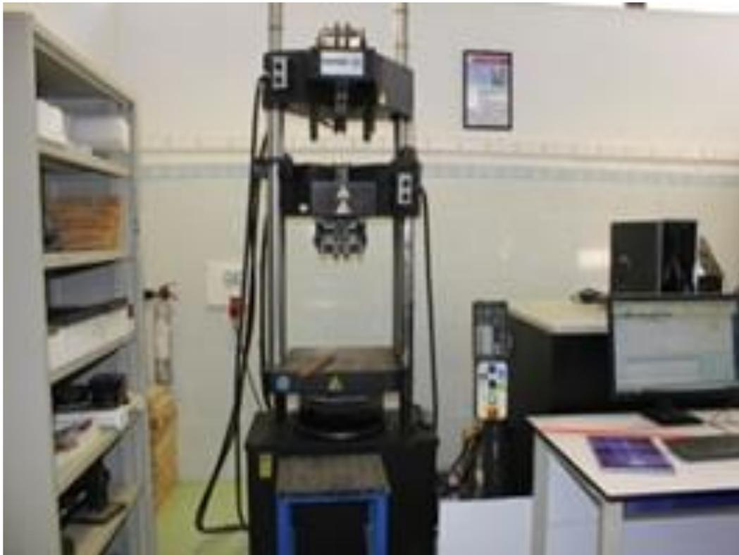
**Figure III. 12 :**Machine de traction Instron.
