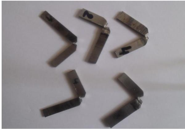
**Figure IV.6:** Eprouvettes après des essais de résiliences
