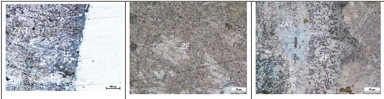
Tableaux IV.2 : Micrographies des joints soudées (grossissement X200)
