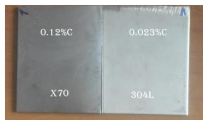
Figure III.1: Matériaux de base utilisés (304L et HSLA-70).
