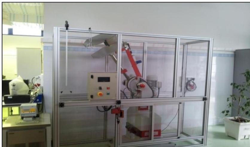
Figure III.10: Mouton pendule ou mouton de Charpy.
