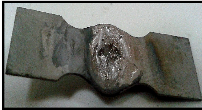
FigureIV.22 Alliage pas totalement évaporé.
