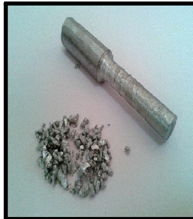
FigureIV.3. C) La barre obtenus par moulage, D) Copeauxobtenus par chariotage.
