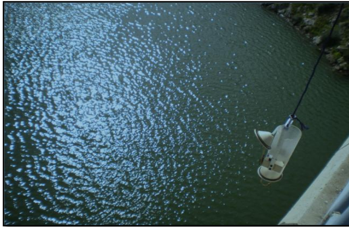
Figure 8: Echantillonnage d'eau du barrage ( Djermakoye H ,2004).
