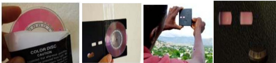
Figure 4: Colorimètre pour la mesure de chlore (source coopération Suisse/DINEPA).
