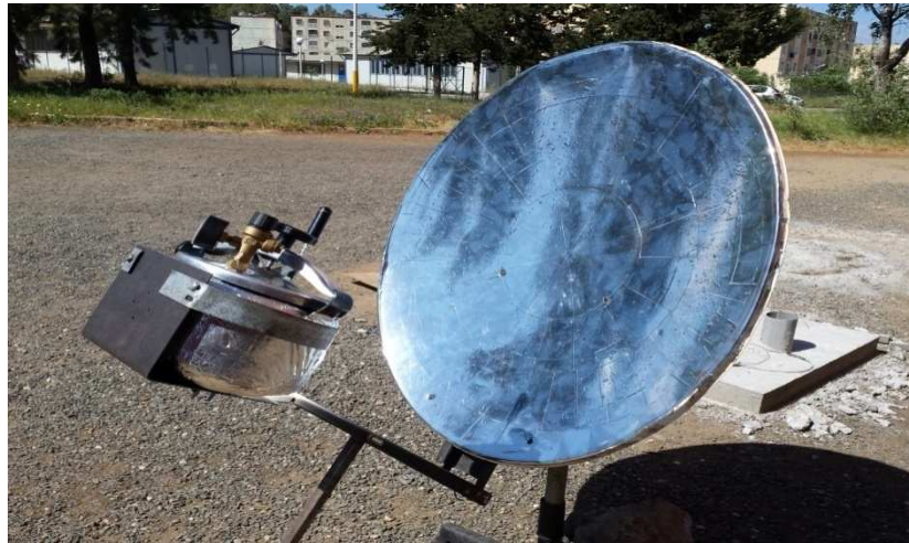
Photo IV 4 : Vue générale du prototype du concentrateur parabolique
