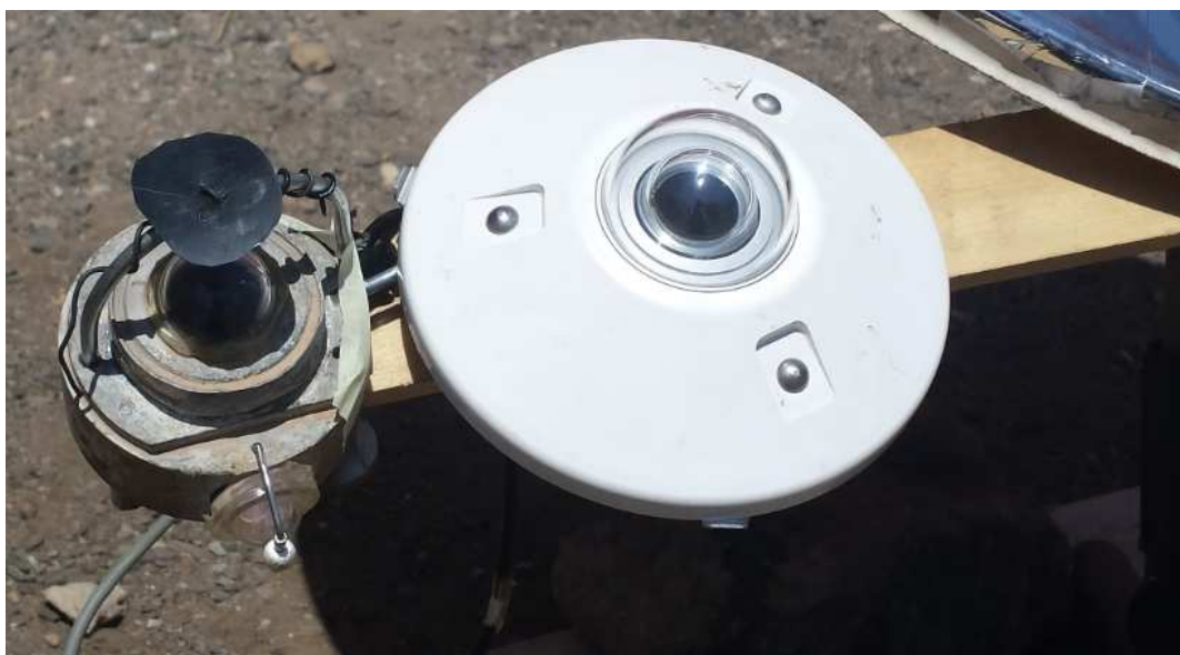
Photo IV 11 : Les deux pyranomètres sont fixé sur un support attaché à l'axe de la parabole.
