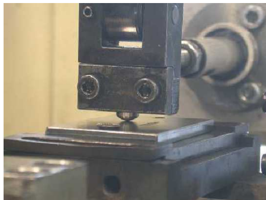
Figure II.3 : Schéma du tribomètre Pion-plan alternatif [34].
