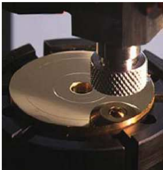
Figure II.4 : Schéma du tribomètre pion-disque rotatif [34].
