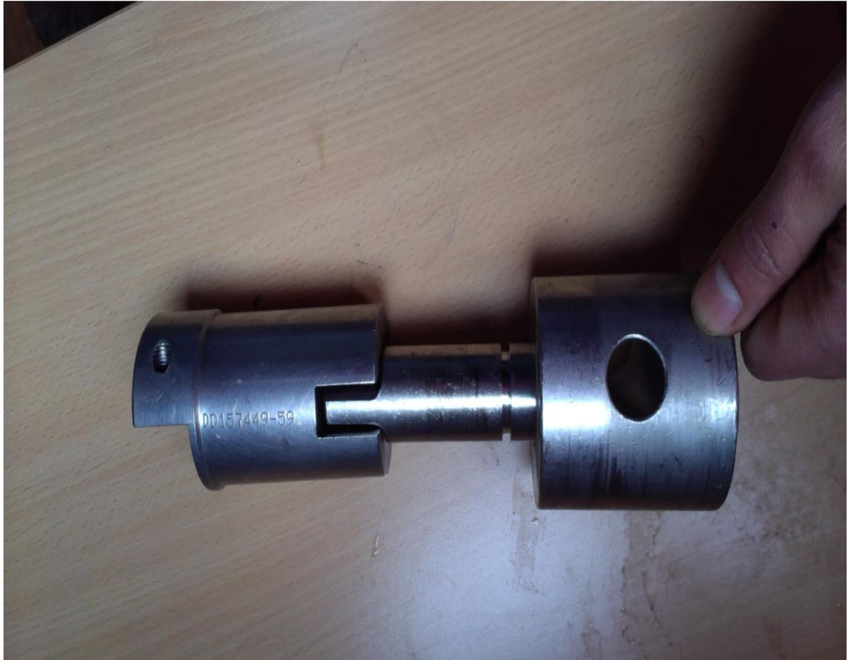
**Figure II-6 : Assemblage Boisseau et Le Manchon.**
