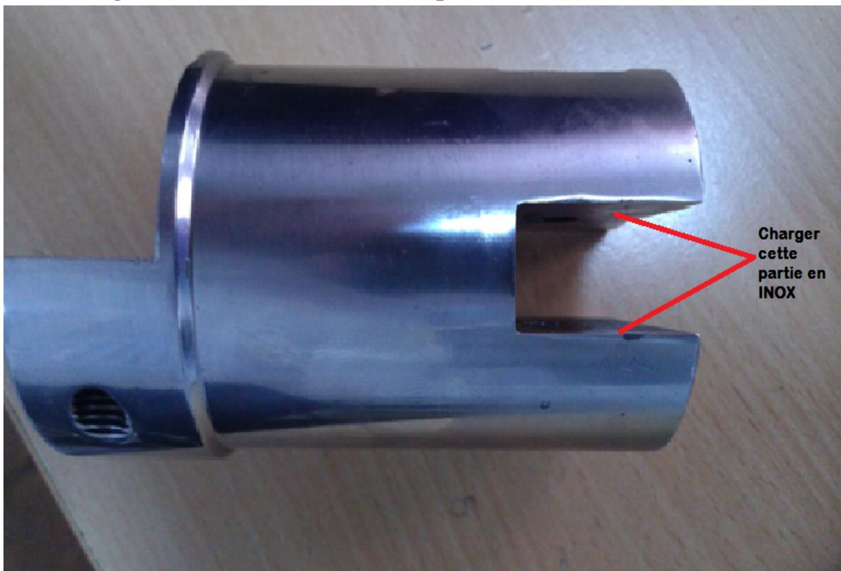
**Figure III-12 Manchon d'accouplement après la réalisation.**
