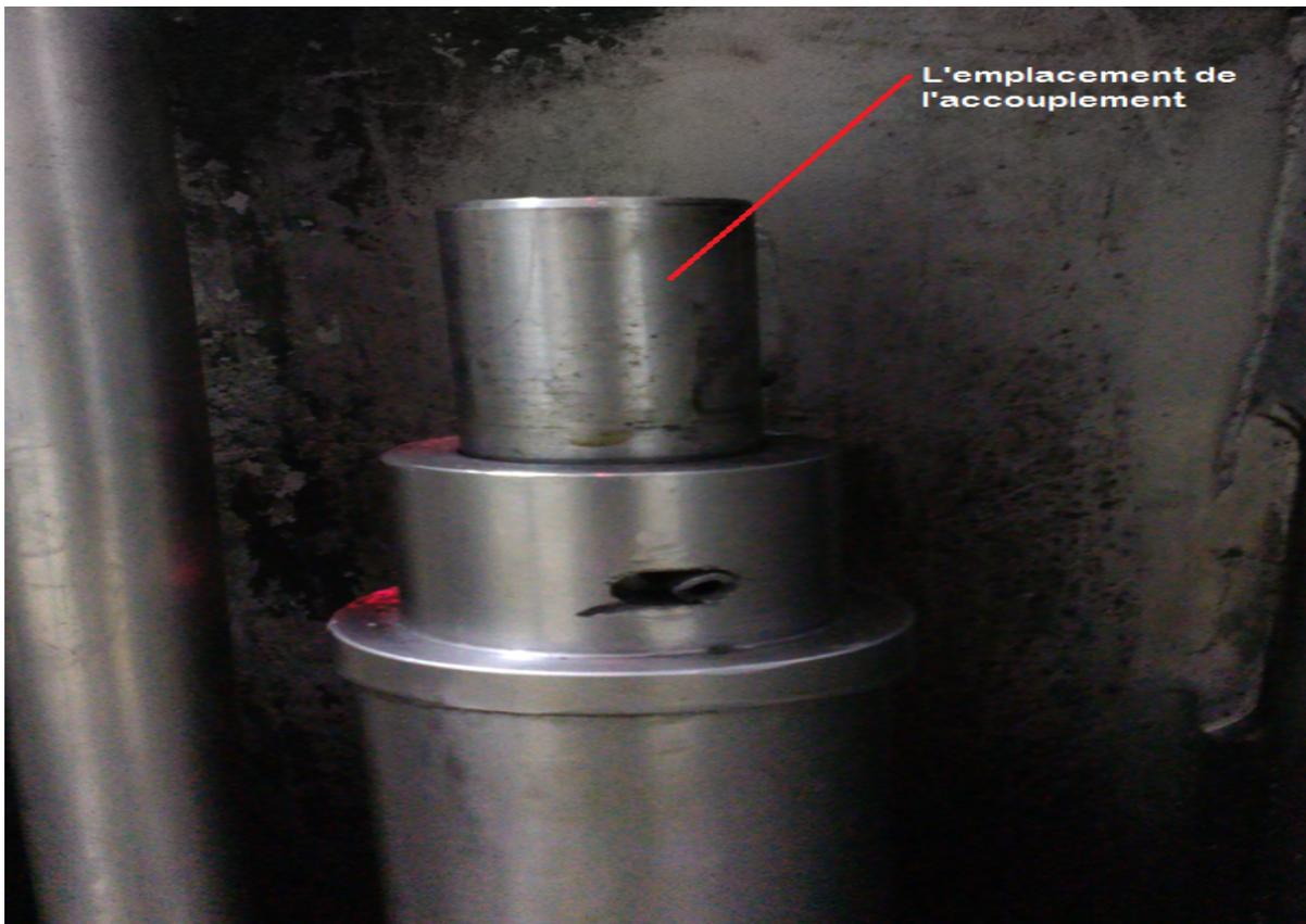
**Figure III-6-A-1 L'emplacement de l'accouplement.**
