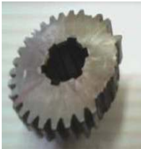
Figure II-14 : Rupture par fatigue.
