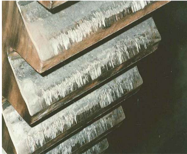
Figure II.18 : Phénomène de grippage localisé
