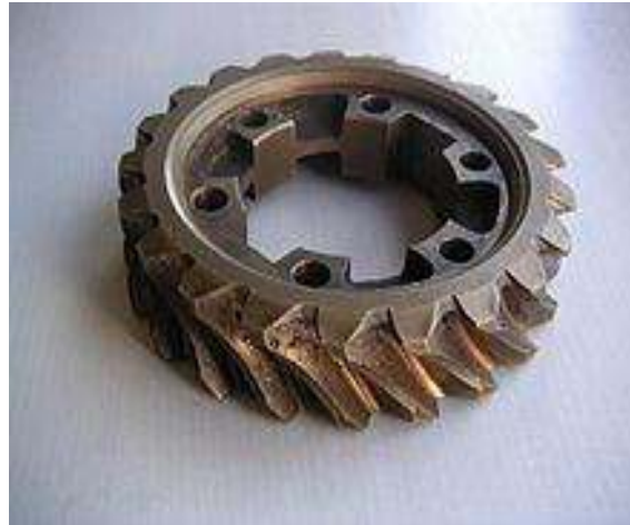
Figure II.19 : Phénomène de grippage généralisé
