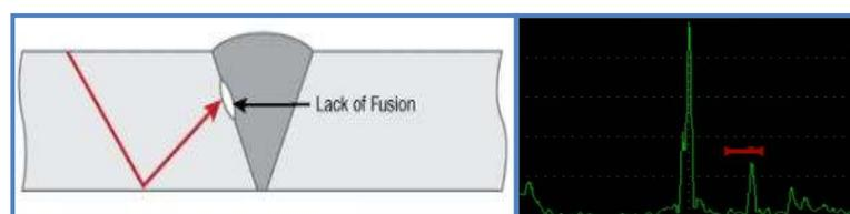
**Figure IV.18:** Manque de fusion et son amplitude d'écho
