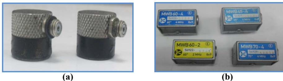
Figure III.3: Transducteurs Piézoélectriques (a) à ondes longitudinales (b) à ondes transversales.
