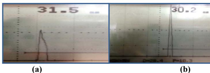
Figure V.22: Écho de mouvement traversant (a) position 02 (b) position 01.
