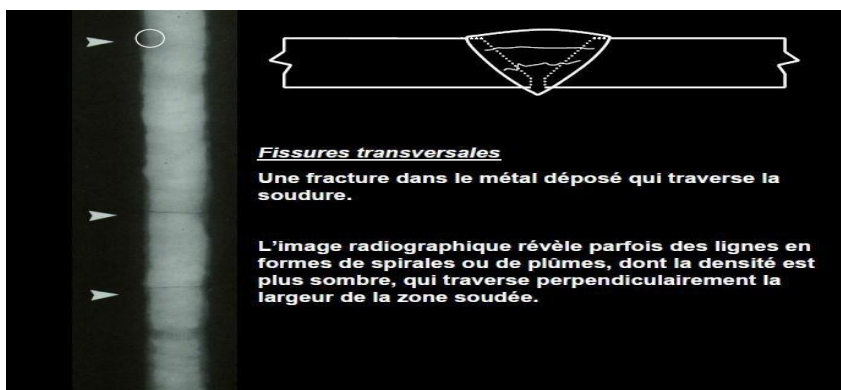
Figure 3.36 : L'image radiographique fissure transversale [11]
