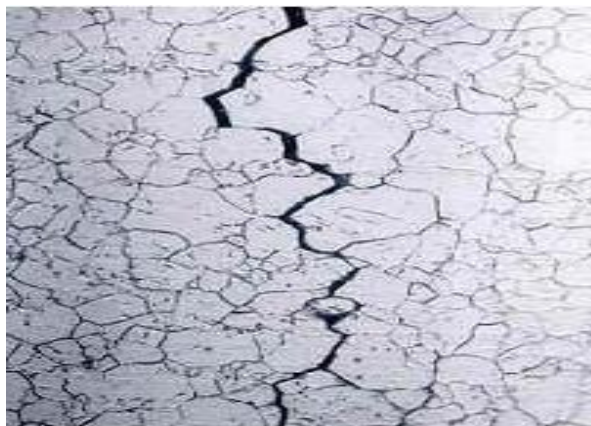
Figure 5.53 : Corrosion intergranulaire d'un inox.
