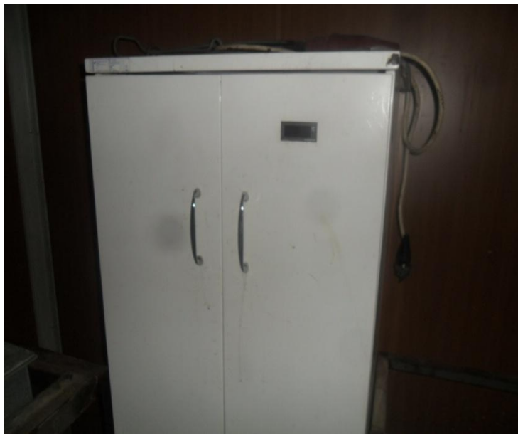
Figure 3.33 : le four de séchage des cuves
