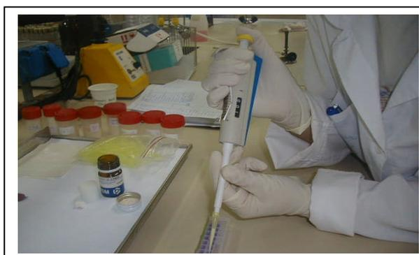
Figure 6. 19: Dépôt de l'échantillon de lait dans la cupule ou puit.
