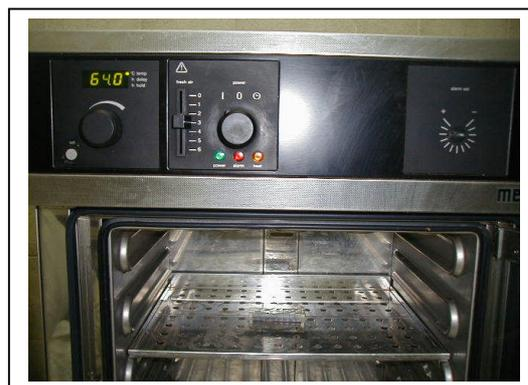
Figure 6. 21 : Incubation du bloc à  $64^{\circ}\text{C} \pm 0,5^{\circ}\text{C}$
