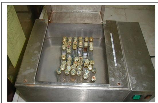
Figure 6. 23 : Chauffage des échantillons de laits à  $80^{\circ}\text{C} \pm 1^{\circ}\text{C}$  pendant 10 minutes.
