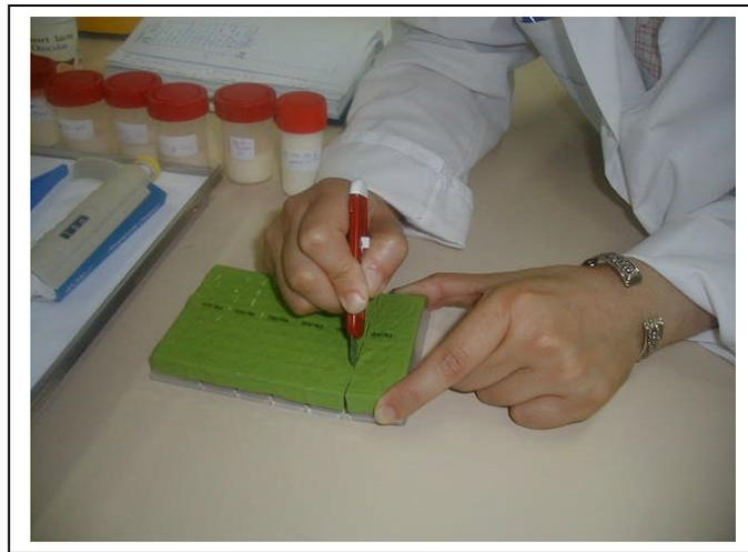
Figure 6. 16 : Découpage de la feuille d'aluminium et détachement du bloc.
