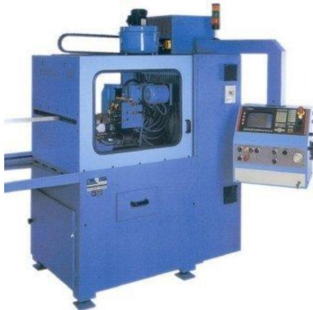
Fig. I.11 : Fraiseuse multibroches
