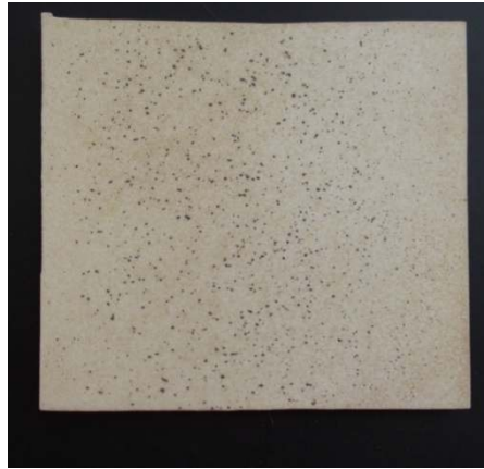
Figure 4.3: Revêtement de bronze déposé à 500 mm du substrat sans apport d'air.
