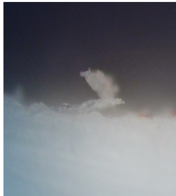
Figure 4.13: Coupe transversale A-A de la lamelle d'aluminium sur substrat rugueux en ABS
