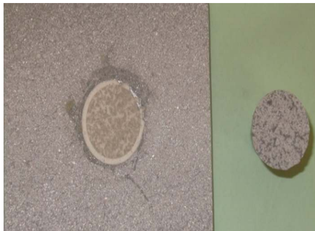
Figure 4.18: Faciès de rupture du revêtement d'Al déposé à l'arc électrique sur substrat en ABS rugueux.
