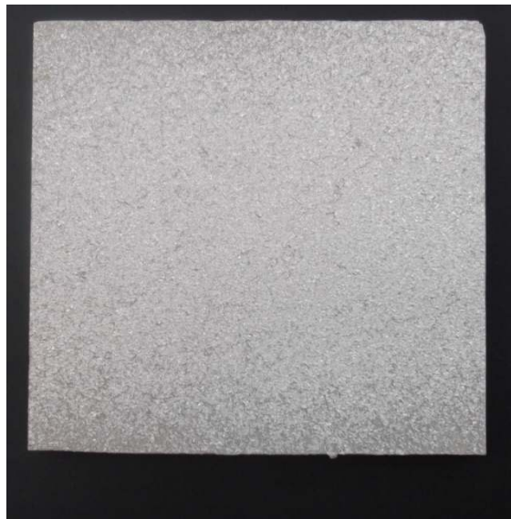
Figure 4. 5: Revêtement d'Al déposé à 300 mm du substrat sans refroidissement à l'air
