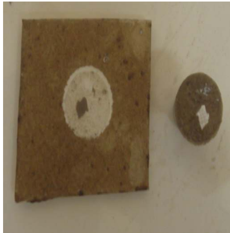
Figure 4.19: Faciès de rupture du revêtement de bronze déposé à la torche à flamme sur substrat en ABS non rugueux.
