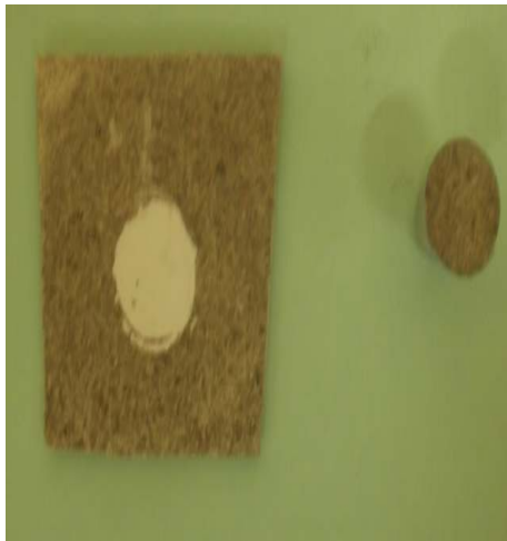
Figure 4.20: Faciès de rupture du revêtement d'Al déposé à l'arc électrique sur substrat en ABS non rugueux.
