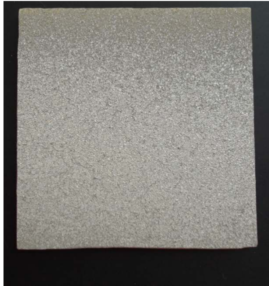
Figure 4.6: Revêtement d'Al déposé à 400 mm à l'arc électrique sans refroidissement d'air.
