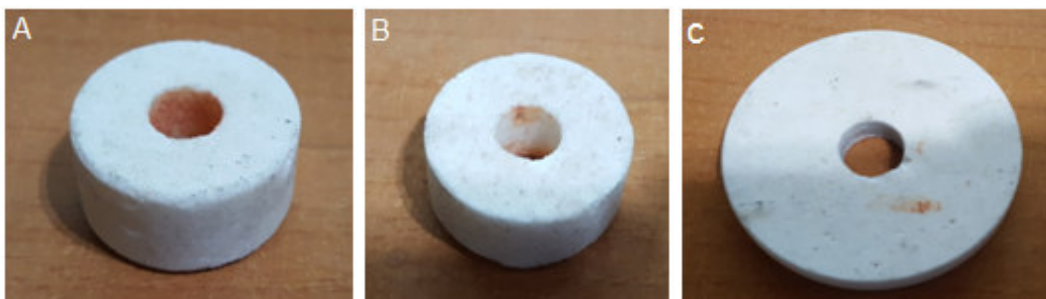
Figure 3.12 Meules en feutre A , B: Meule mou, et C Meule dur
