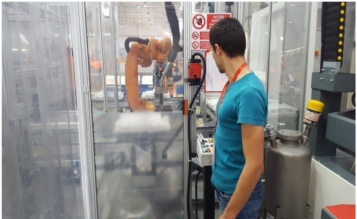
Figure1.1 Bras manipulateur à six axes avec un outil de Plasma
