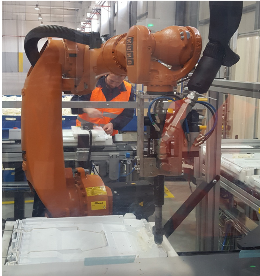
Figure1.2 Bras manipulateur à six axes avec un outil du Colle
