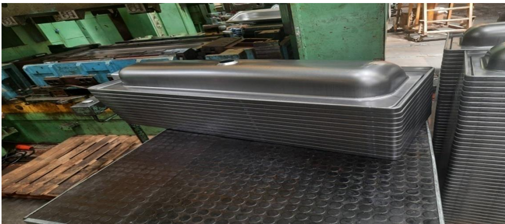
Figure II.13 : La forme de tombage bord horizontal sur lavabo collectif
