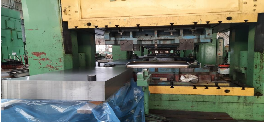
Figure II.3 : Presse d'emboutissage des lavabos collectif.
