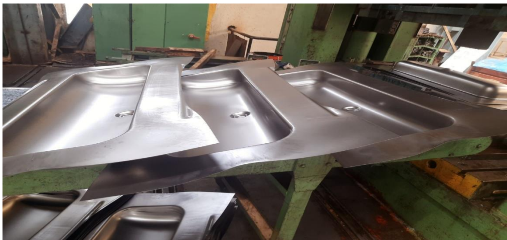
Figure II.5: Opération de la forme lavabo collectif
