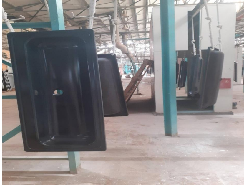
Figure II.17 : Passage au four pour caisson.
