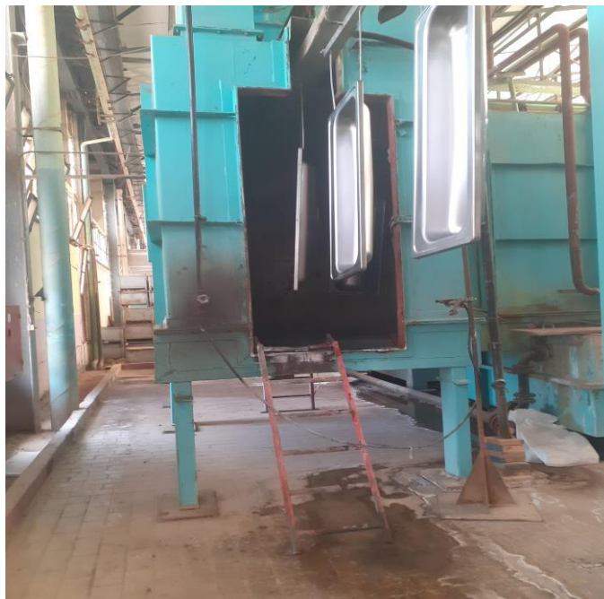
Figure II.15 : Ligne de nettoyage des lavabos collectifs.
