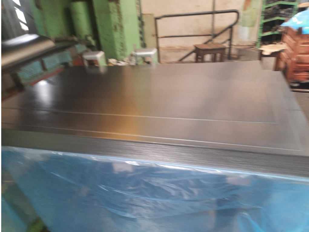
Figure II.2: Tôles d'emboutissage des lavabos collectif.
