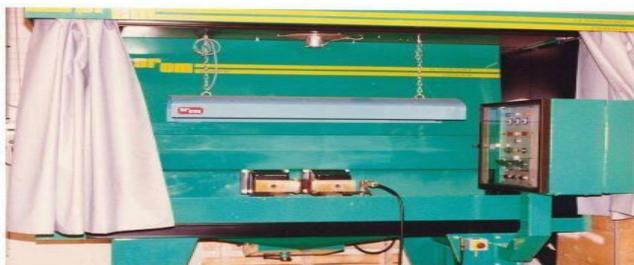
Figure IV. 34: Contrôle par magnétoscopie
