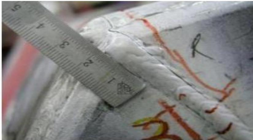
Figure IV. 12: Exemples de fissures
