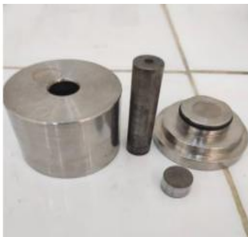
Figure III.4 Un dispositif de compactage
