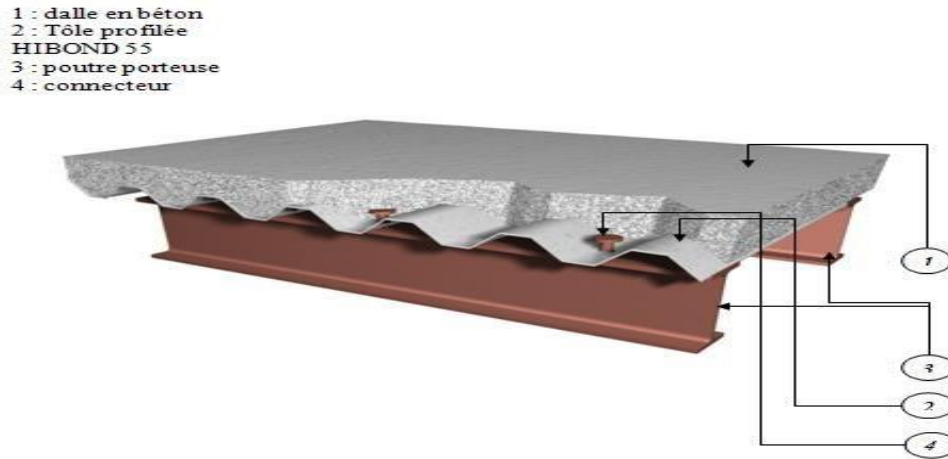
Figure II.1: Schéma des composants de plancher
