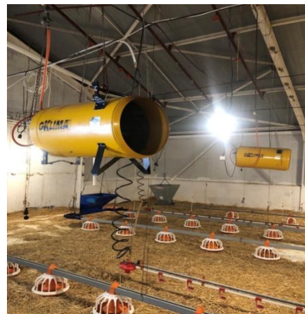
Figure23 : Éleveuse a gaz (photo personnelle ,2024)
