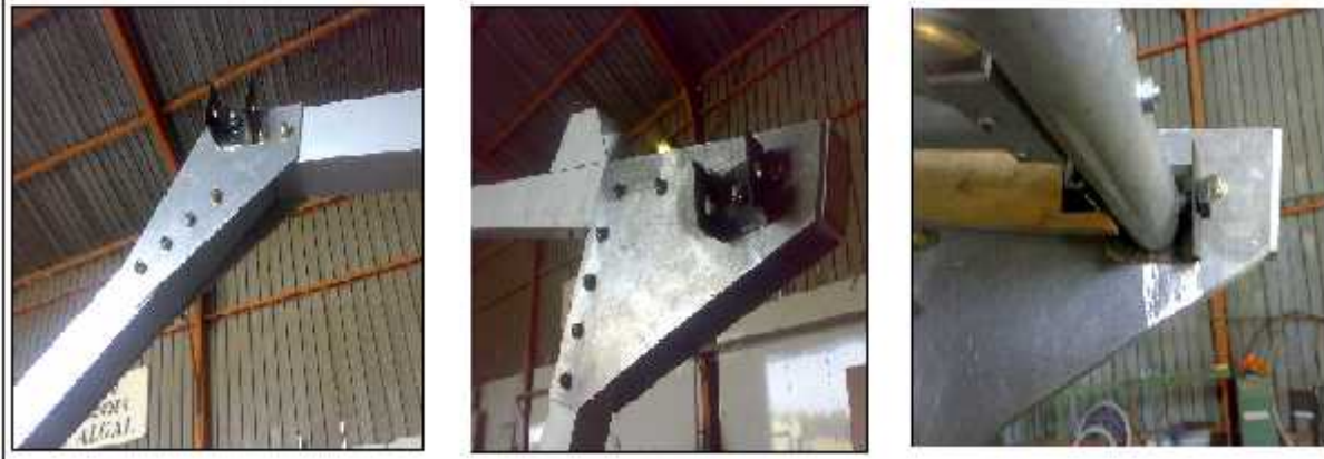
Figure (IV-20) Les fixations des ailes au niveau du châssis
