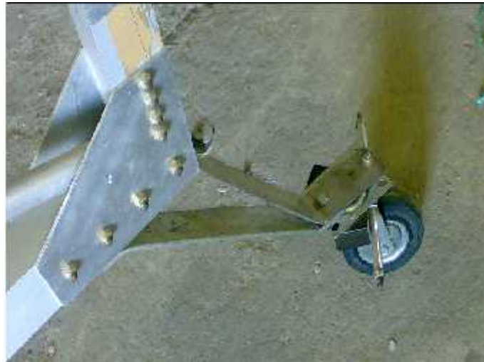
Figure (IV-7) Le train arrière réalisé
