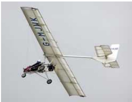
Figure (I-3.a) Un multi-axes à structure tubulaire entoilé
