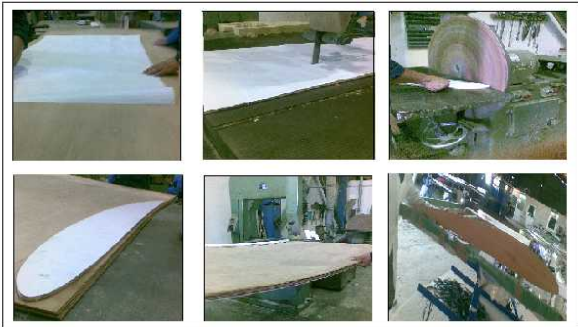
Figure (IV-15) Les étapes de la réalisation des nervures
