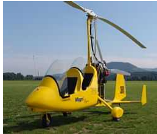
Figure (I-4.b) Un autogire biplace en matériaux composite
