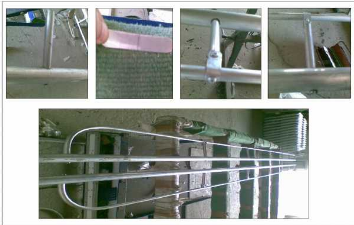
Figure (IV-18) Les étapes de la réalisation des ailerons
