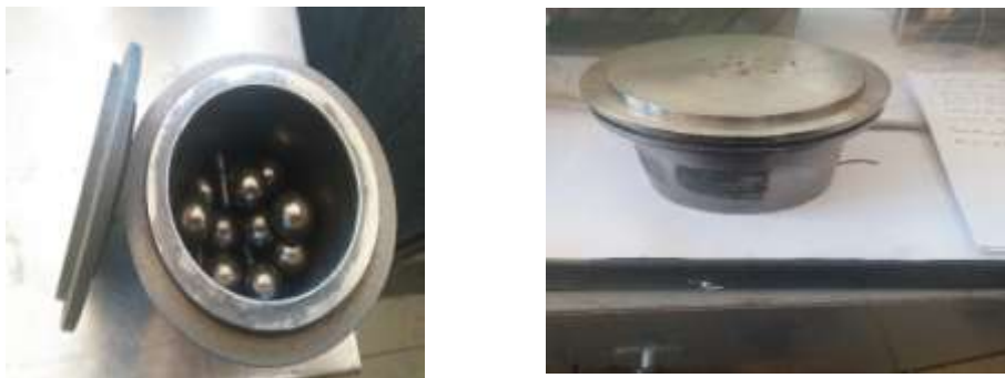
Figure 2- 2: Modèle de jarres et billes utilisées pendant le broyage.
