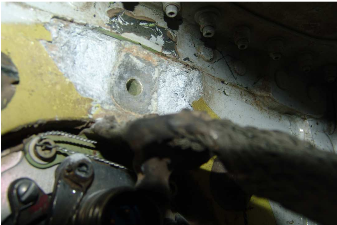
Figure (III.4) : Corrosion au niveau de la fixation du fil de masse
