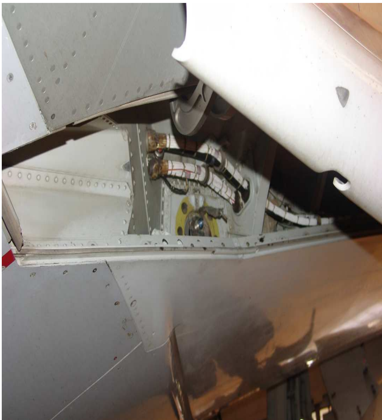
Figure (III.2) : Localisation de la pompe droite du réservoir
