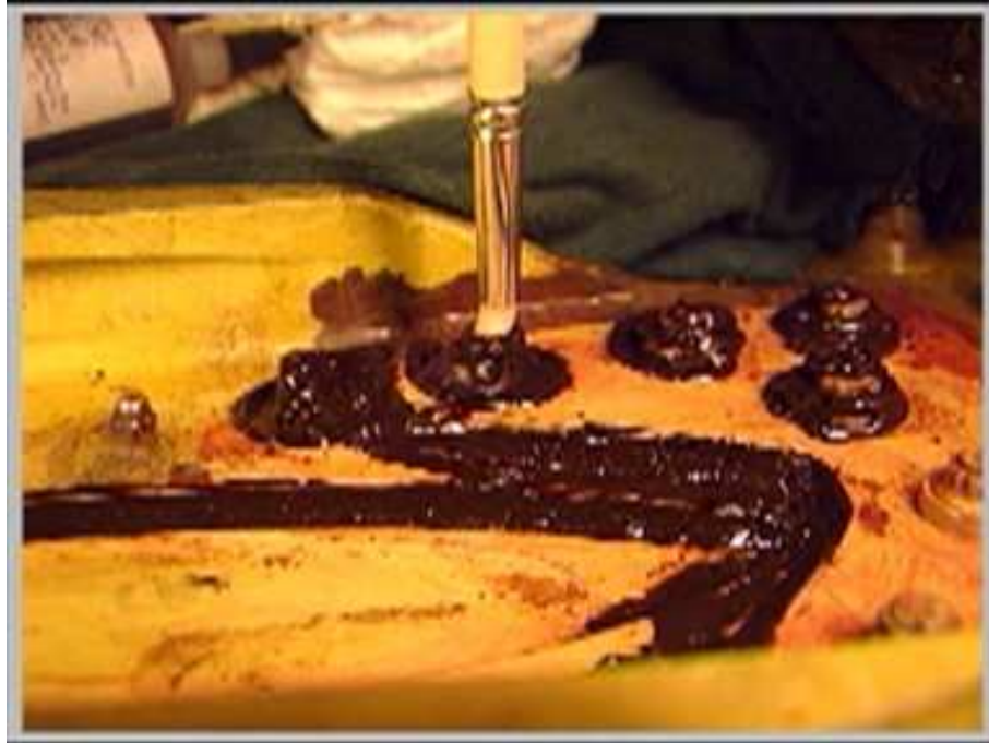
Figure (IV.4) : Application du PR sur les rivets
