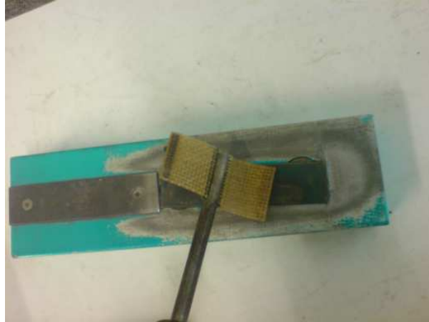
Figure (III.20) : Ecroissage de l'éprouvette
