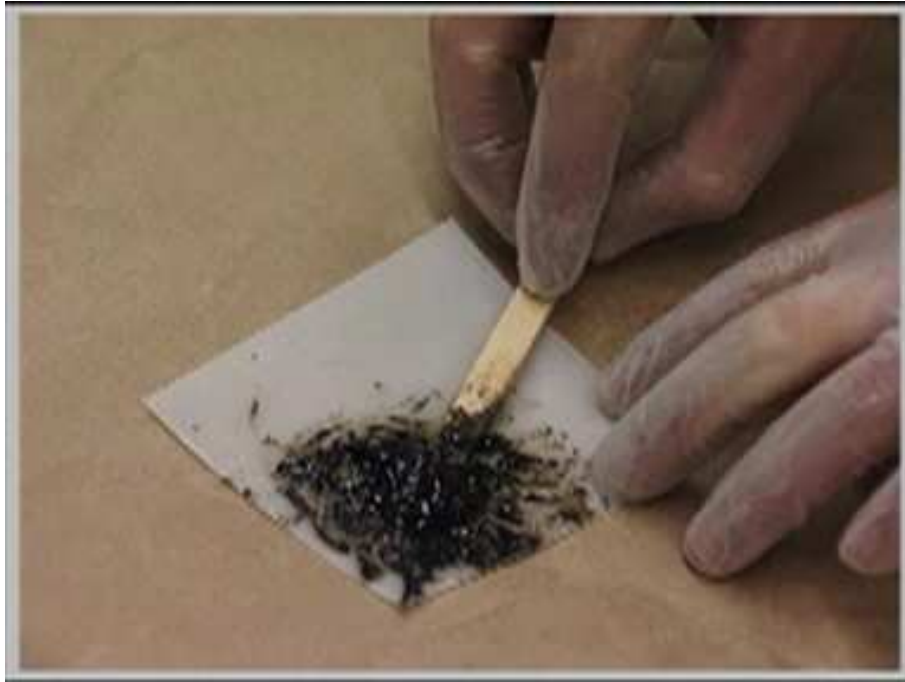
Figure (IV.3) : Instruction du mélange du mastic
