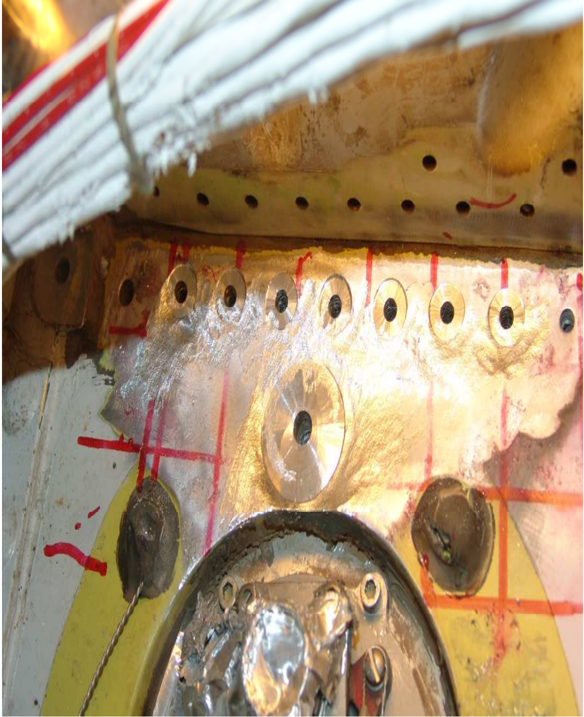
Figure (III.17) : Photo prise après le lamage autour des trous de fixation
