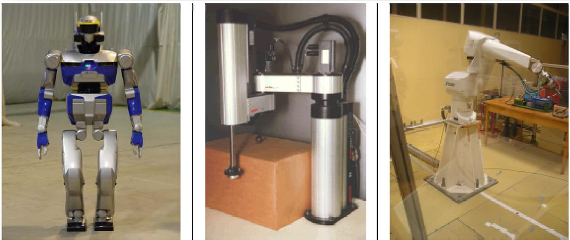
**Figure 1 1: Robot humanoïde - Robot série de type SCARA - Robot série anthropomorphe.**
