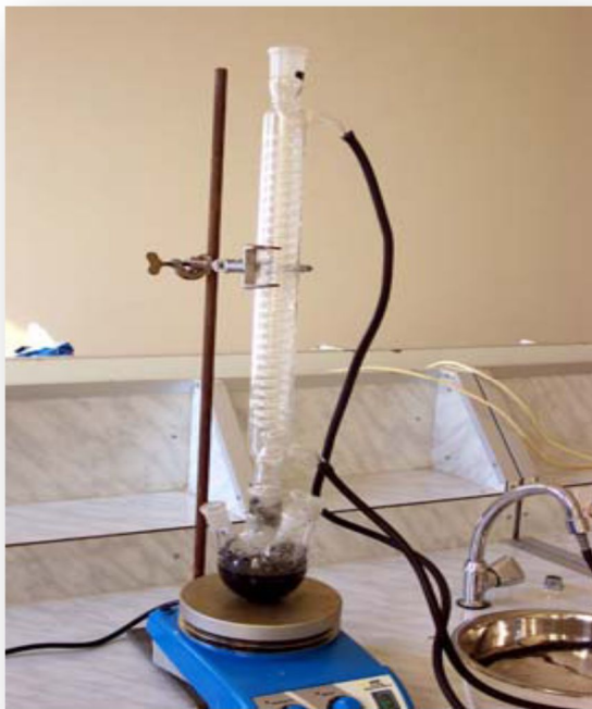
Photo 1: Dispositif d'activation chimique du charbon actif valorisé
