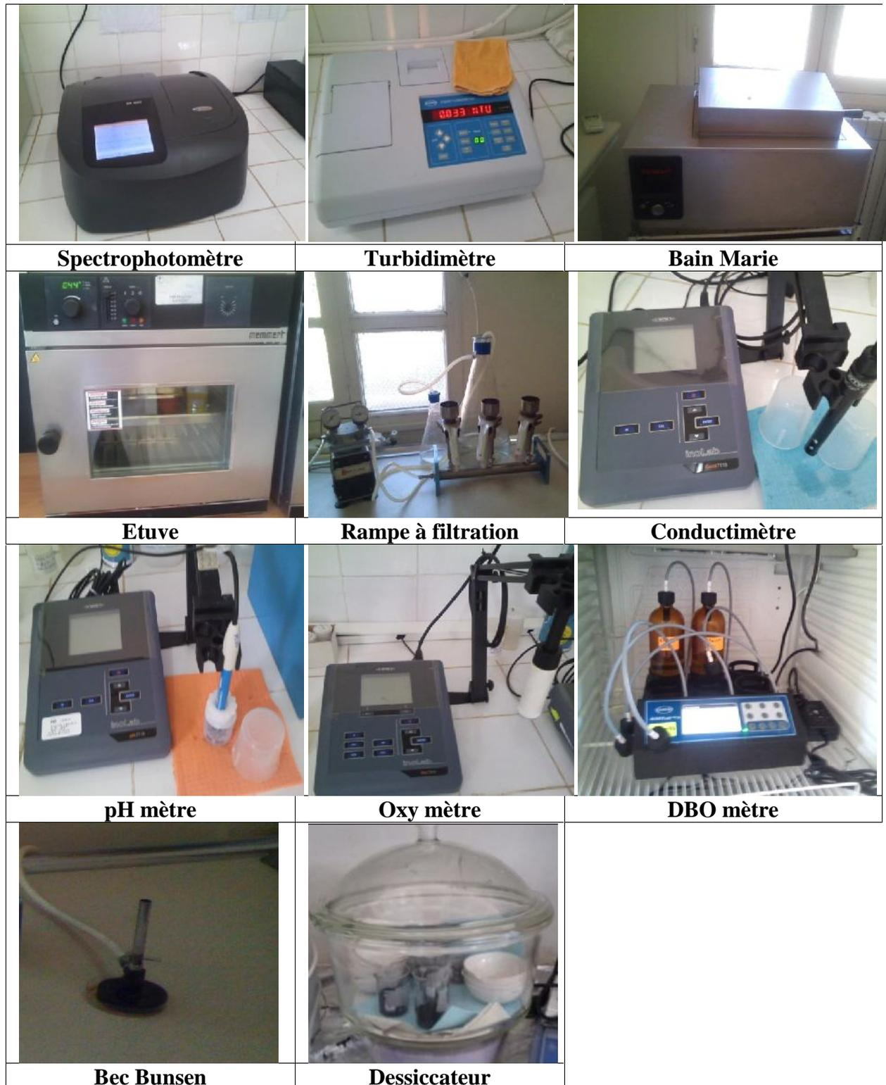
**Figure 30:** Appareils utilisés lors des analyses (photos originales, 2015)
