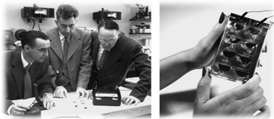
Figure (II-2) Les inventeurs de la première cellule solaire "réelle": Chapin, Fuller et Pearson. La figure à droite montre le premier module solaire au monde (mini module de 8 cellules solaires)
