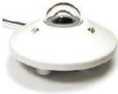
Figure I-11 Pyranomètre d'Eppley. Pour éliminer le rayonnement direct, certains pyranomètres sont munis d'un cache à orienter suivant la saison pour suivre la déclinaison [21].
