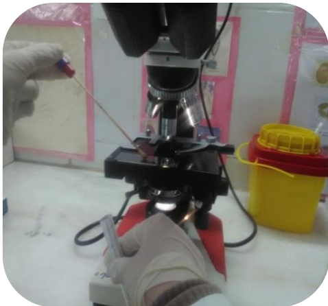
5- Prélever une goutte et la dépose sur une lame puis la recouvrir par une lamelle.
