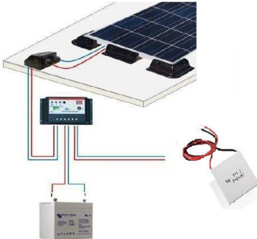
Figure (III.7) : Schéma de l'installation.
