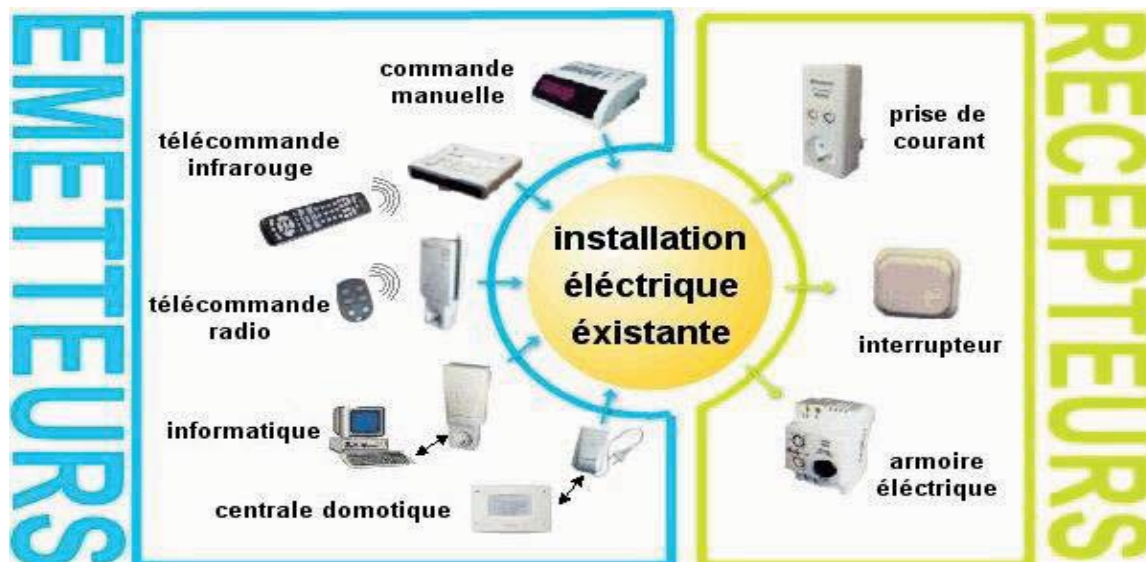
Figure 25 exemple d'une installation avec prise CPL. [17]
