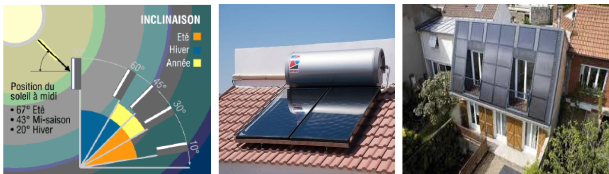
Figure 38 L'intégration idéal des capteurs solaires. [30]
