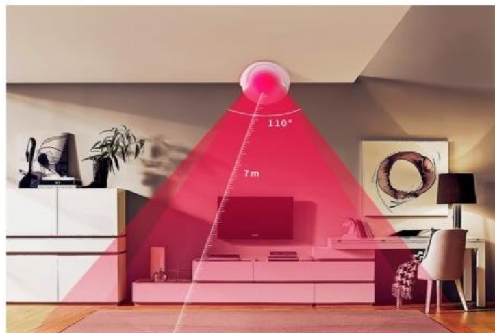
Figure 31 Mise en place du détecteur de mouvement(PIR). [25]
