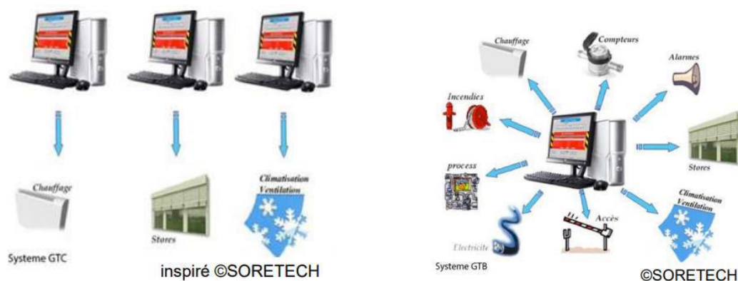
Figure 37 Schéma explicatif des solutions GTC et GTB. [2]
