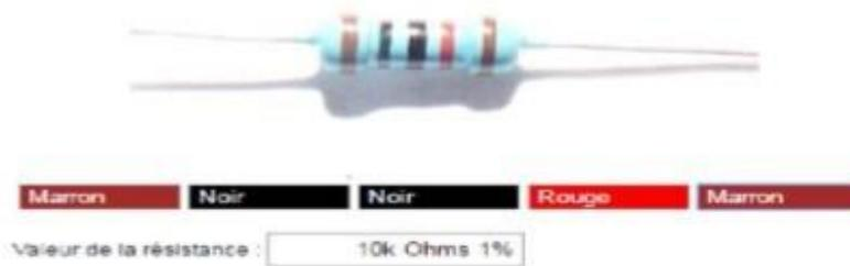
Figure.III.1 Résistance d'une capacité 10 k $\Omega$
