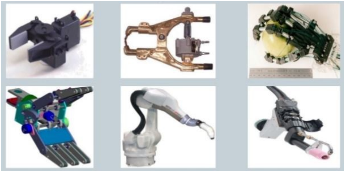
Figure 1.9. Exemples de différents organes terminaux. [33].
