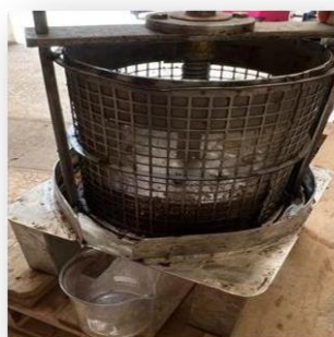
Figure I.10 : Pressage de la matière grasse (originale 2024).
