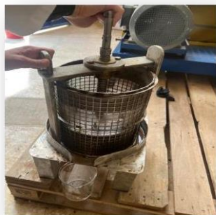
Figure I.2 : Pressage de la matière grasse et l'excès d'eau (originale 2024).
