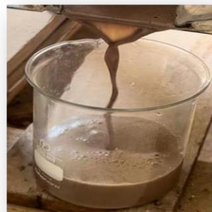
Figure I.2 : Pressage de la matière grasse et l'excès d'eau (originale 2024).
