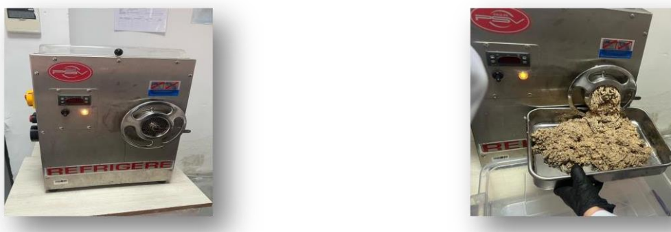
Figure I.9 : Broyage des déchets (originale 2024).
